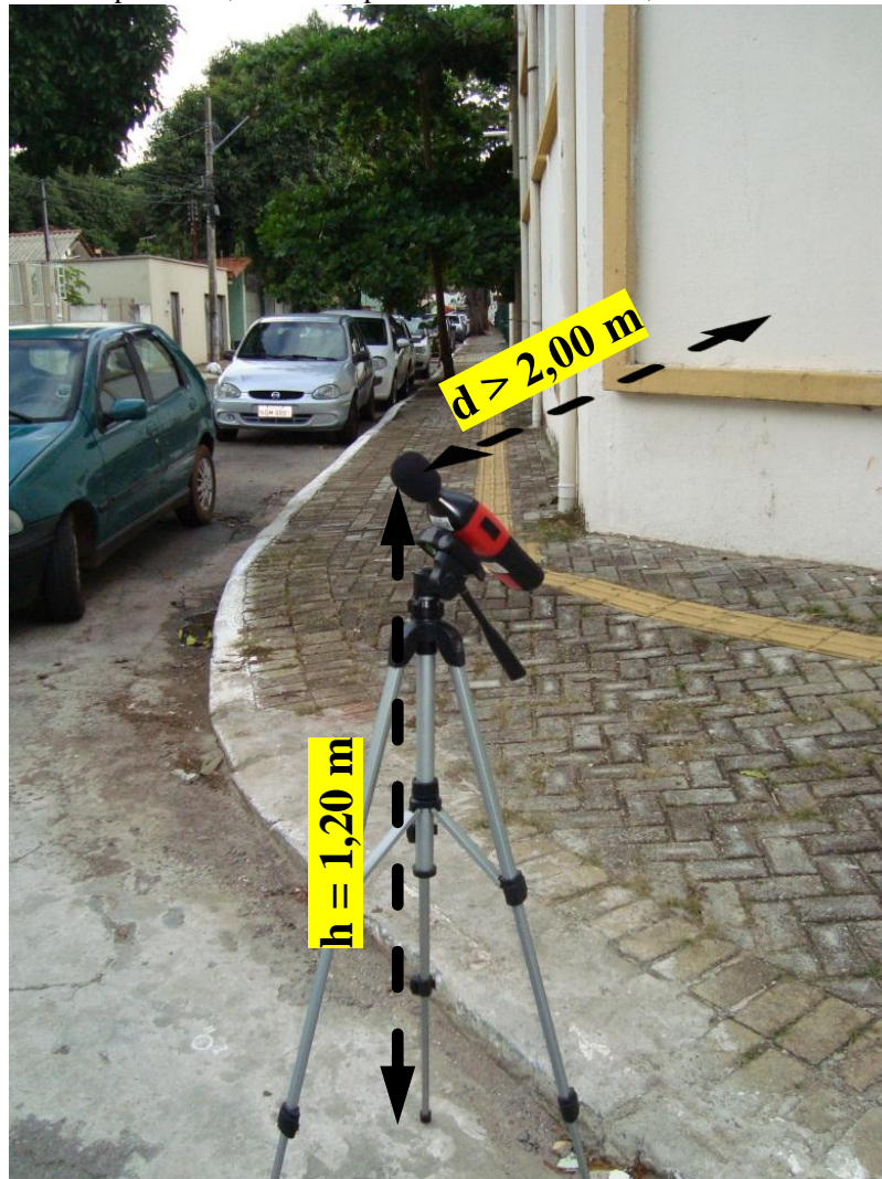
Figura 5 - Medição realizada na área externa, esquina da Rua 62 com Rua 79, Centro de Goiânia. Distância superior a 2,00 m de superfícies refletoras e a 1,20 m do solo.
