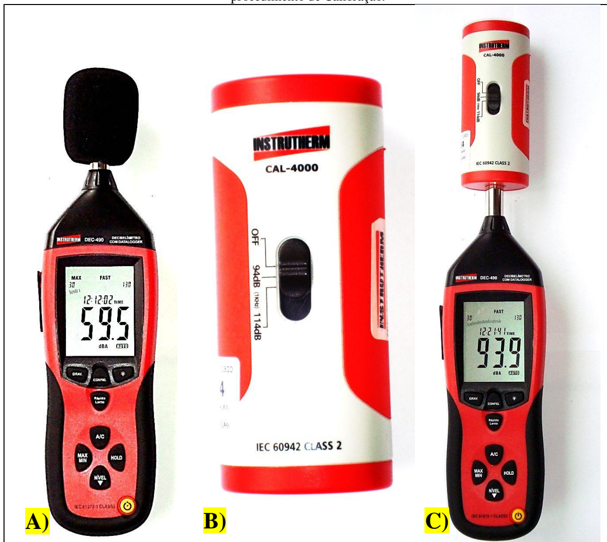
Figura 4 - Equipamentos utilizados nas medições do NPS: A) Medidor de Nível Sonoro DEC-490 (INSTRUTHERM); B) Calibrador Acústico Cal-4000 (INSTRUTHERM); C) Medidor de Nível Sonoro em procedimento de Calibração.
