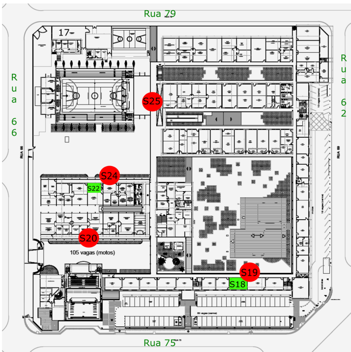
Figura VIII - Planta baixa do IFG - Campus Goiânia (1º Pavimento), com os locais onde foram realizadas medições durante o período vespertino.
