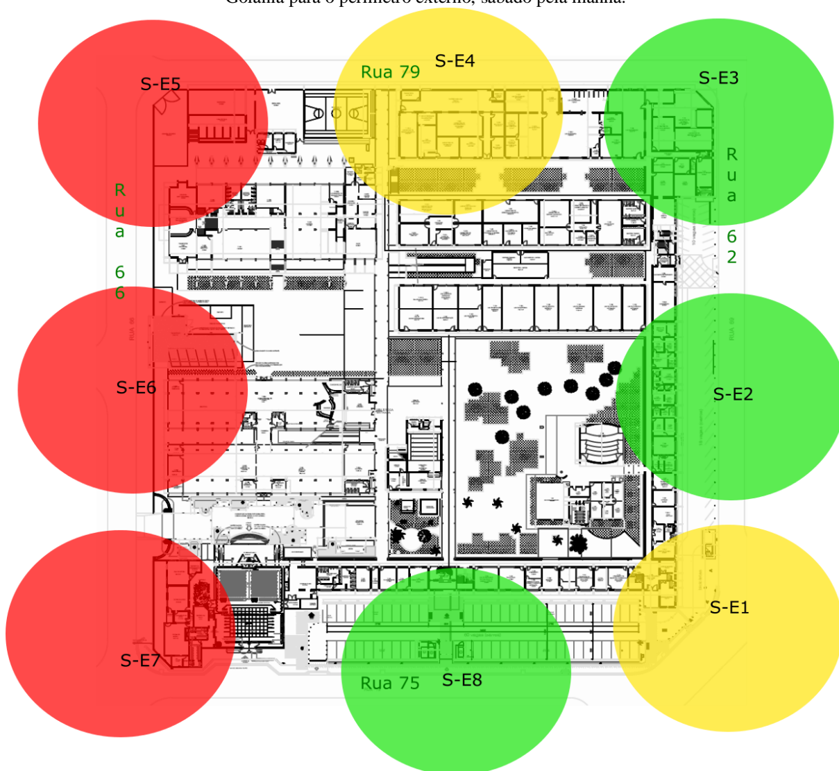
Figura 29 - Representação por cores da comparação do L_{Aeq} com NCA na planta baixa do IFG – Campus Goiânia para o perímetro externo, sábado pela manhã.
